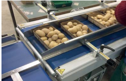
Die Kartoffeltrays werden auf ein Zuführband gelegt.
