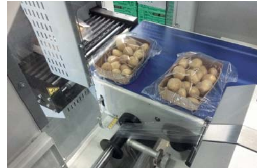
Die Saropacker Maschine schweisst die Trays in Folie ein und führt diese dem Schrumpftunnel zu.
