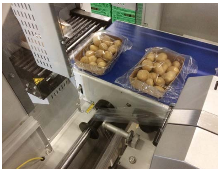
Die SAROPACKER Maschine schweisst die Trays in Folie ein und führt diese dem Schrumpftunnel zu.
